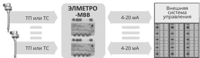
Многоканальный нормирующий преобразователь. Модули собирают данные с термопар и/или термосопротивлений и с помощью токовых выходов передают данные на внешнюю систему управления или регистрацию данных.
