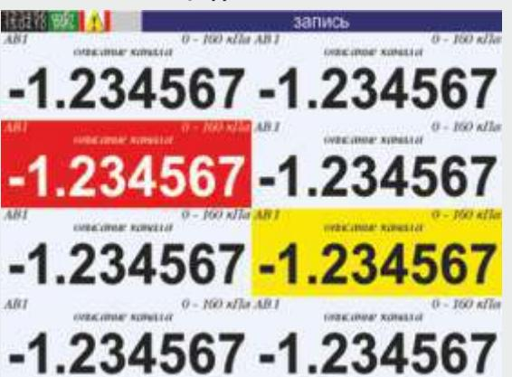
При срабатывании предуставки значение выделяется желтым цветом. При срабатывании уставки – красным.
