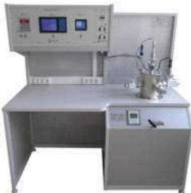
Рис. 12. Стационарная вакуумметрическая поверочная установка
