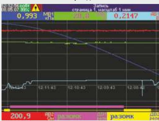
Предусмотрена вертикальная и горизонтальная ориентация трендов, а также отображение на темном и светлом фоне. Масштаб временной оси задаётся при настройке. Для исполнений ВиЭР-104К и ВиЭР-М7 возможно раздельное отображение трендов.
