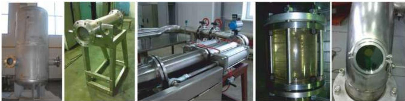
Рис. 30. Сепаратор воздуха.
