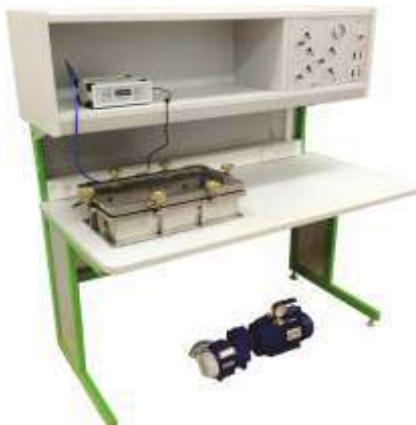
Рис. 10а. Стенд для поверки и калибровки барометров
