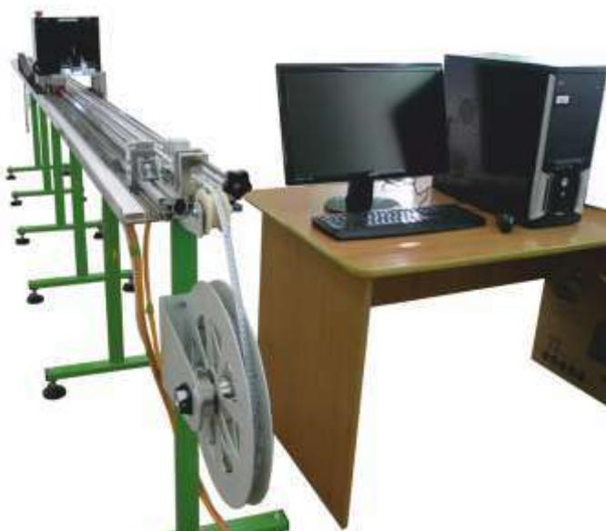
Рис.22. Метрологическая установка для измерения длины ЭЛМЕТРО-ЛИЗА
