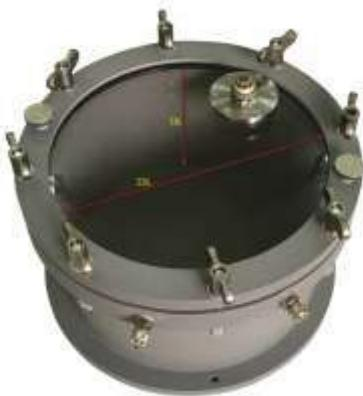
Рис. 10б. Камера круглая со смотровым стеклом и гермовводом
