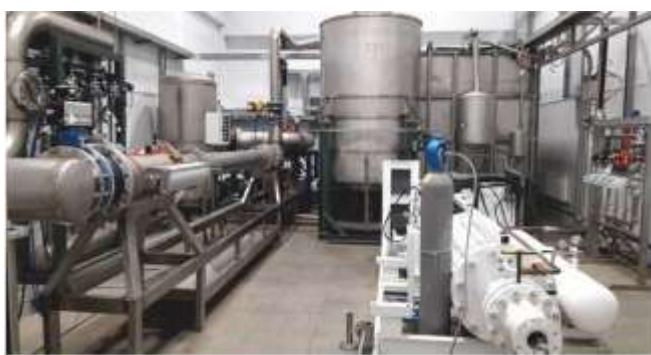
Рис.24. Установка поверочная проливная с расходом 600 м<sup>3</sup>/час
