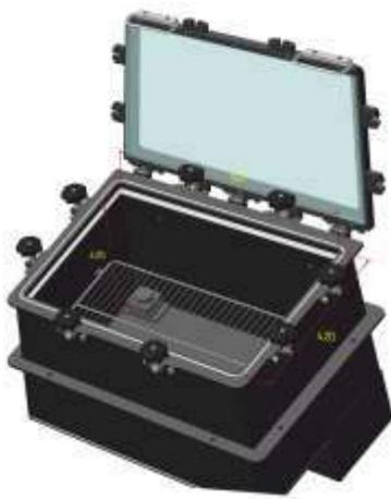
Рис. 10г. Большая камера для поверки большого числа барометров и метеостанций, содержит гермоводы с питанием от сети 220 В и низковольтные разъёмы для подключения вспомогательной периферии (калибраторы, цифровые интерфейсы ПК, преобразователи)
