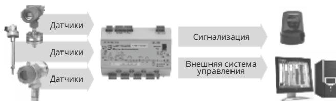
Распределенная система сбора данных. Модули ввода-вывода собирают данные с различных датчиков, преобразуют и передают по различным интерфейсам на верхний уровень АСУТП (контроллер АСУТП, локальная сеть предприятия, автоматизированное рабочее место оператора). При необходимости, модули сигнализируют о неисправностях и/или передают управляющие сигналы на исполнительные механизмы.
