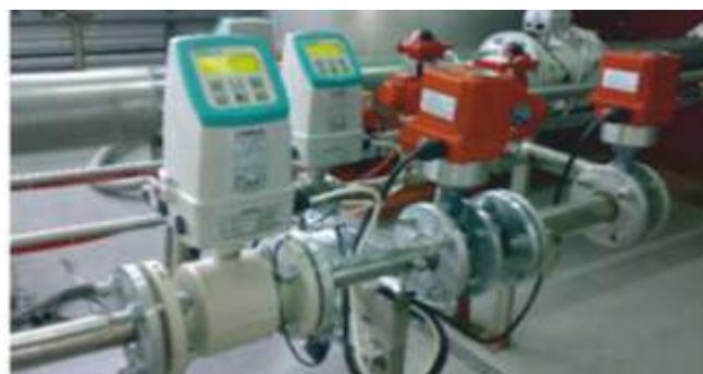
Рис.25. Эталонные (контрольные) счетчики-расходомеры Siemens, Krohne
