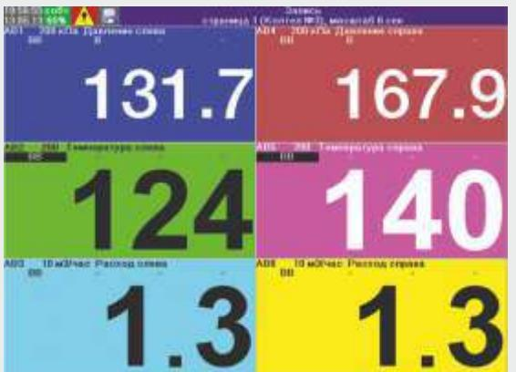
Отображаются: текущее значение сигнала для каждого канала, имя канала, единица измерения, тип и период выборки.
