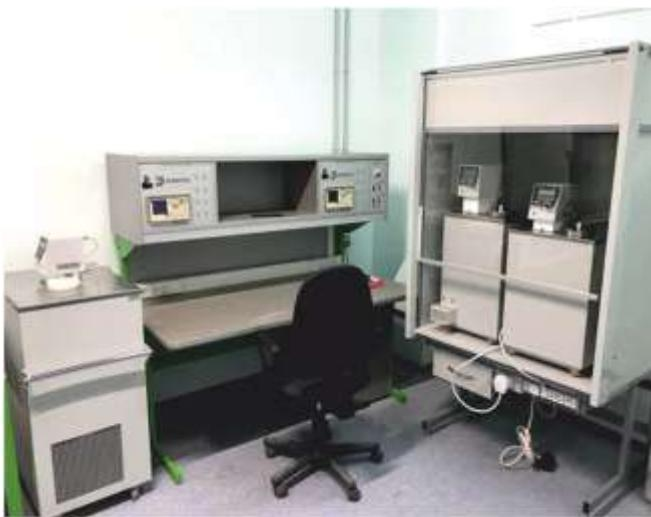
Рис. 15. Стенд поверки, калибровки и ремонта преобразователей температуры
